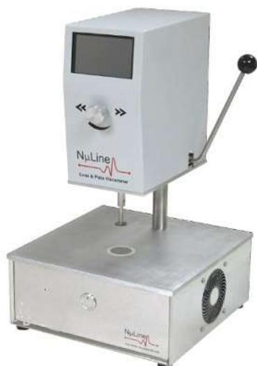
**NuLine** est un viscosimètre cône et plan conçu pour des mesures de contrôle qualité rapides et fiables dans une large gamme d'applications industrielles. Il est facile à nettoyer et à entretenir dans les environnements de fabrication les plus difficiles et permet de mesurer une large gamme de viscosité grâce à des cônes de différentes tailles entièrement interchangeables.
