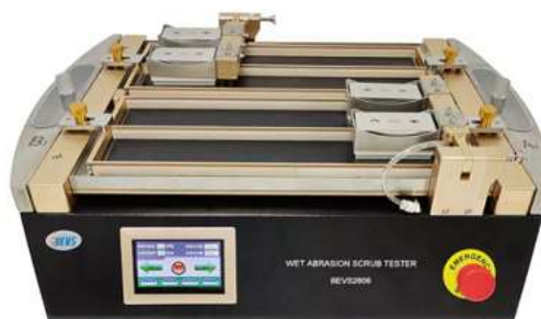
Réf. 2806 : 4 pistes - vitesses ajustables 1- 60 cycles par min – 2 pompes – 2 moteurs
