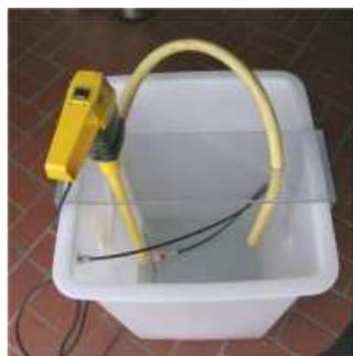
Le réservoir est rempli d'eau pure et la quantité de sel nécessaire est versée en 1 seule fois. Puis une plaque en plexiglass fournie avec la pompe est posée sur le réservoir. La pompe est alors posée sur cette plaque. La pompe est activée jusqu'à dissolution complète du sel par circulation (environ 10 à 15 minutes).
