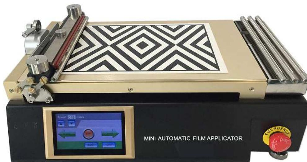
Ces mini **applicateurs automatiques de film** ont un faible encombrement et sont constitués de composants de haute précision, sont robustes et ont un design anti-vibration, ce qui garantit des résultats répétables et fiables à long terme.
