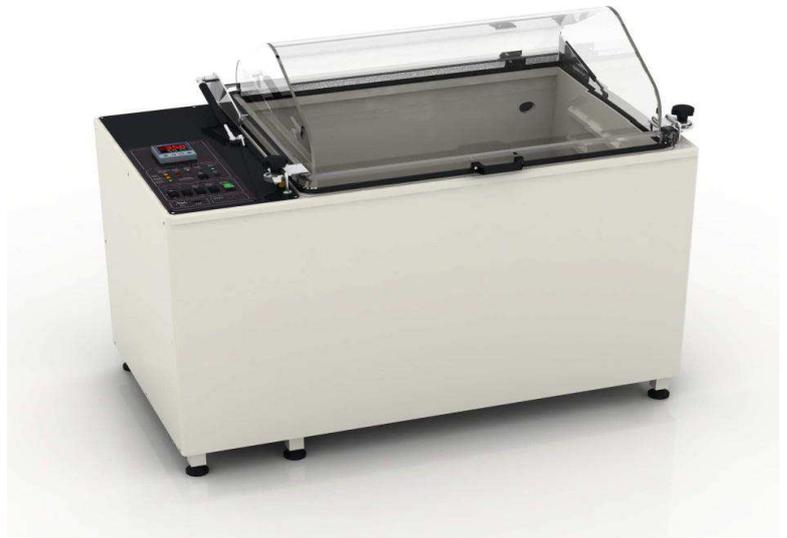
Selon les modèles, ces enceintes permettent de réaliser les essais d'humidité / de condensation selon ISO 6270-2:2005 / ASTM D2247 :
