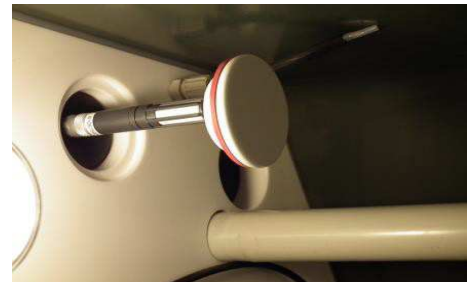
Sonde d'humidité se rétractant automatiquement dans la paroi durant les phases de B.S pour la protéger de la corrosion.
