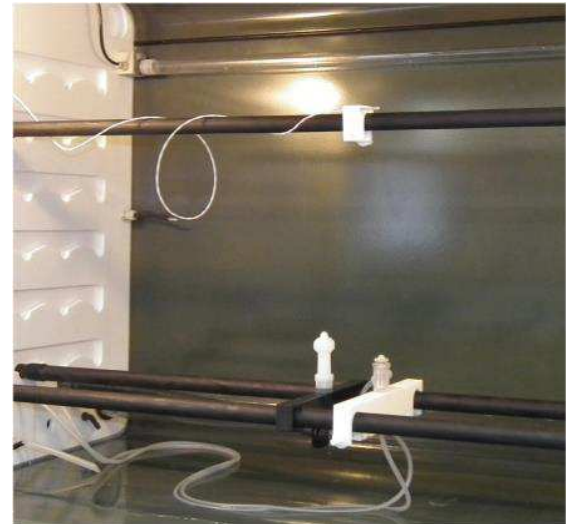
Buse en acrylique haute performance pour une distribution et une génération optimale du brouillard salin et deuxième buse pour le rinçage / lavage automatique de la chambre à l'eau déminéralisée la fin de l'essai.
