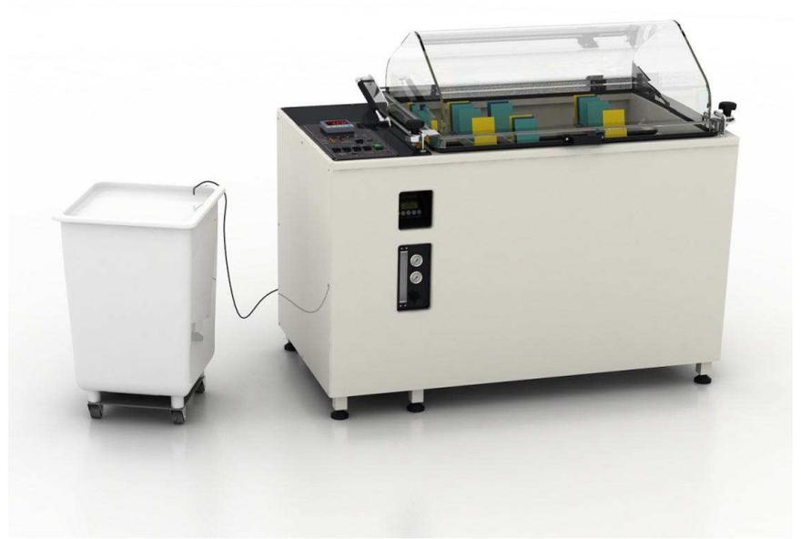
Enceinte cyclique à chargement par le dessus de 600 litres compacte et facile à utiliser. Equipé d'une PLC (Beckhoff) à écran tactile intuitif sous Windows CE, elle est conçue pour effectuer dans la même enceinte des essais de corrosion accélérés cycliques VDA 621-415 et VW PV 1210 (module climatique en option), les brouillards salin constants NSS (neutre), AASS (acétique) et CASS (cupro-acétique) et essais humidité / condensation selon NF EN ISO 6270-2:2005 (CH, AT, AHT)
