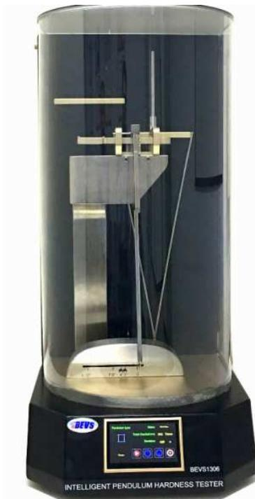
Un appareil normalisé pour évaluer la dureté des revêtements selon König ou Persoz. Le test consiste à mesurer le temps d'amortissement d'un pendule oscillant sur une surface-test. L'amplitude d'oscillation du pendule, qui dépend de la dureté, est détectée grâce aux faisceaux photoélectriques du pendule. Elle décroît plus vite sur les surfaces souples.
