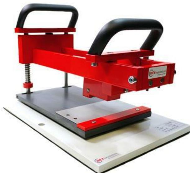
Cet instrument permet de réaliser les essais d'adhérence par quadrillage selon ISO 2409 / ASTM D3359, sans effort et de manière répétable, quel que soit l'opérateur et pour un investissement très raisonnable.
