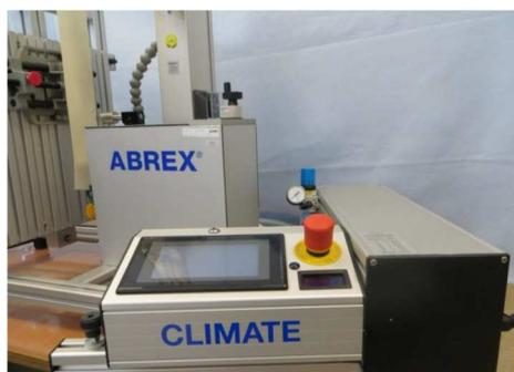
ABREX® C pour installation dans enceinte climatique, gamme de température -40° C to +85° C
