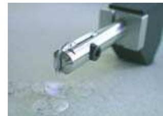
**Fixation pour essai d'abrasion sur billets de banque :**
